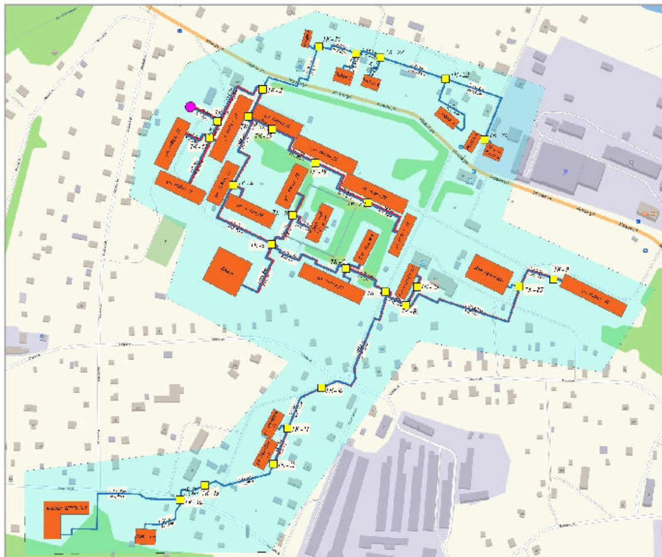
Рисунок 1.4 – Зона действия централизованного теплоснабжения котельной д. Заклинье
