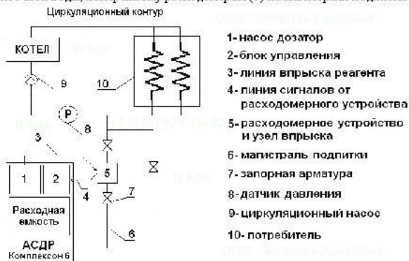
Рис 1.6. Принцип работы ВПУ
