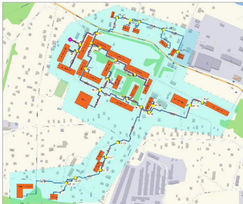
Рисунок 1.4 – Зона действия централизованного теплоснабжения котельной д. Заклинье
